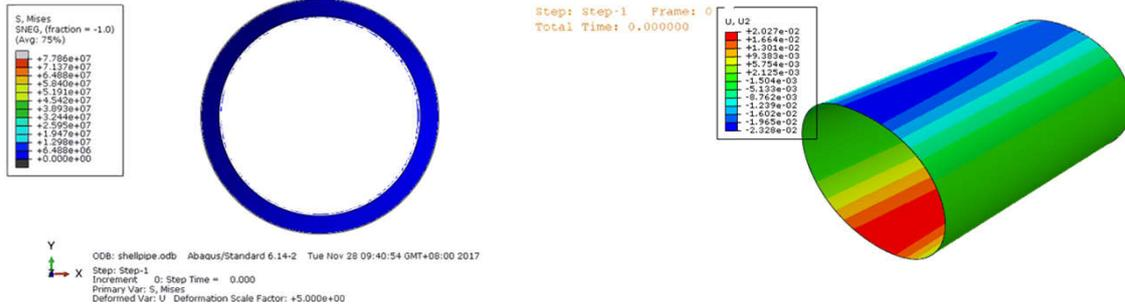
**变形: 竖向变形为管顶管底位移和**
