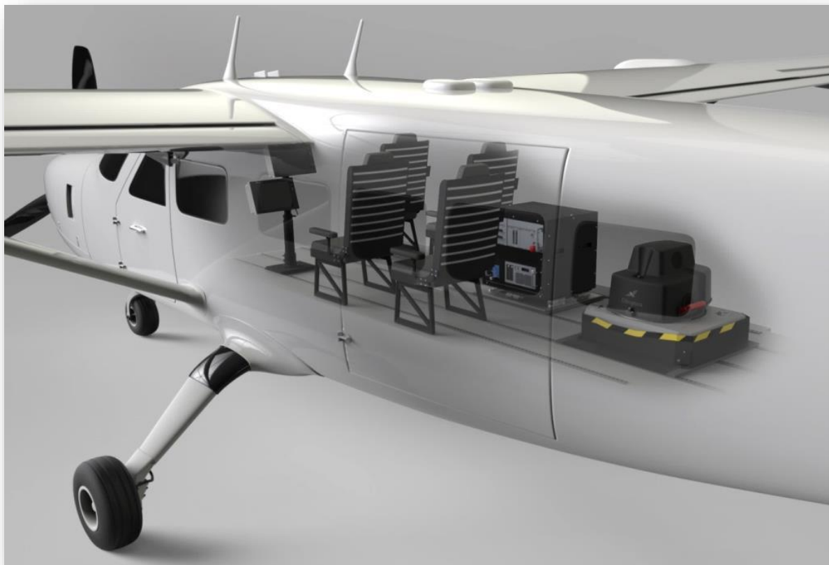
Chiroptera II installation 蝙蝠II 安装示意
