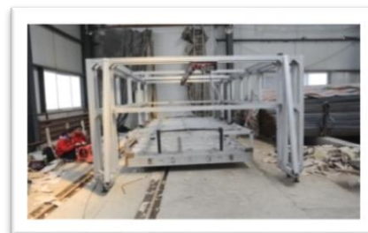
ATPIS轨道板自动化检测系统
