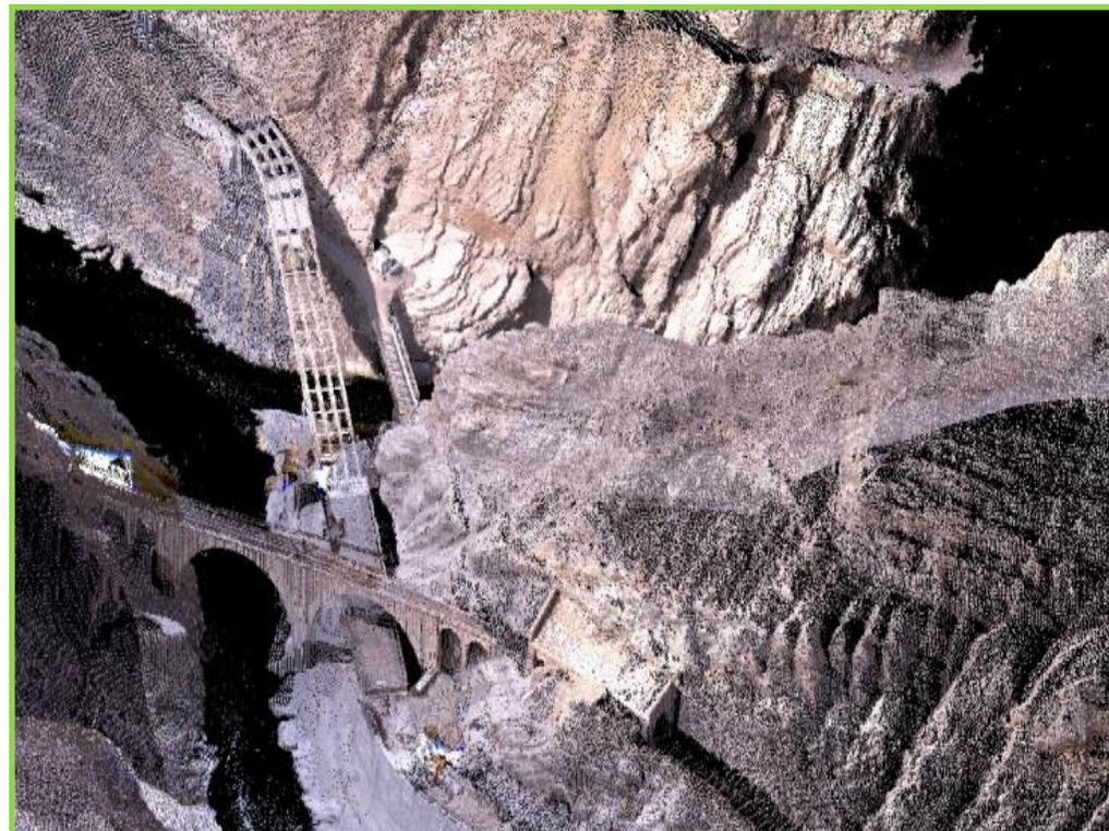
地面三维激光扫描仪采集数据生成的三维点云数字模型
