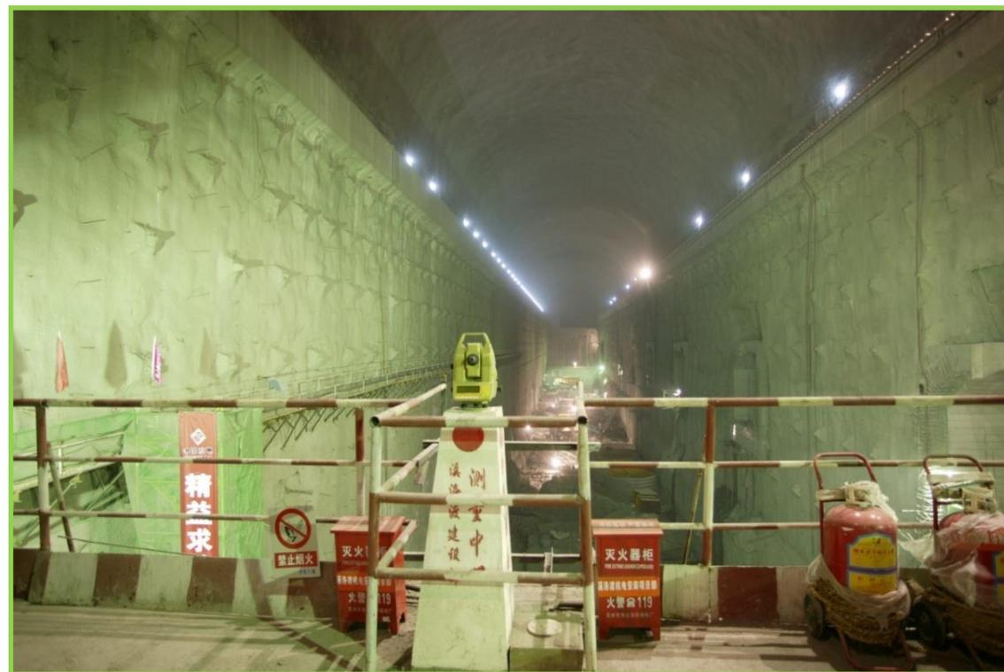
TCA2003测量机器人在溪洛渡右岸地下厂房控制网观测
