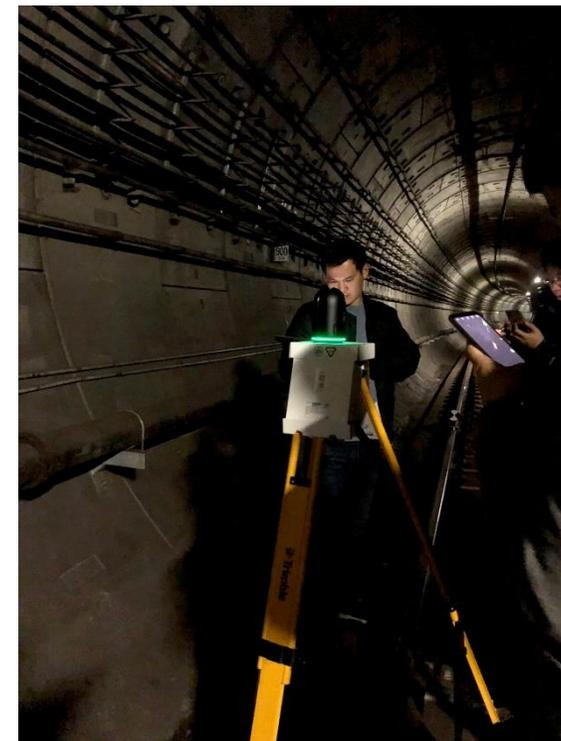
三维激光扫描技术是集**激光扫描技术、实时定位技术、姿态测量技术、通信技术、计算机技术**为一体的检测系统，其可快速获取隧道表面大量的点的三维坐标和图像灰度值等信息
